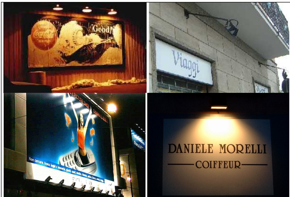
Fig.9 – Alto-Destra: Sulla destra un'insegna di esercizio conforme alla L.p. 16/07 con emissione di 0 cd/klm a 90° ed oltre.
