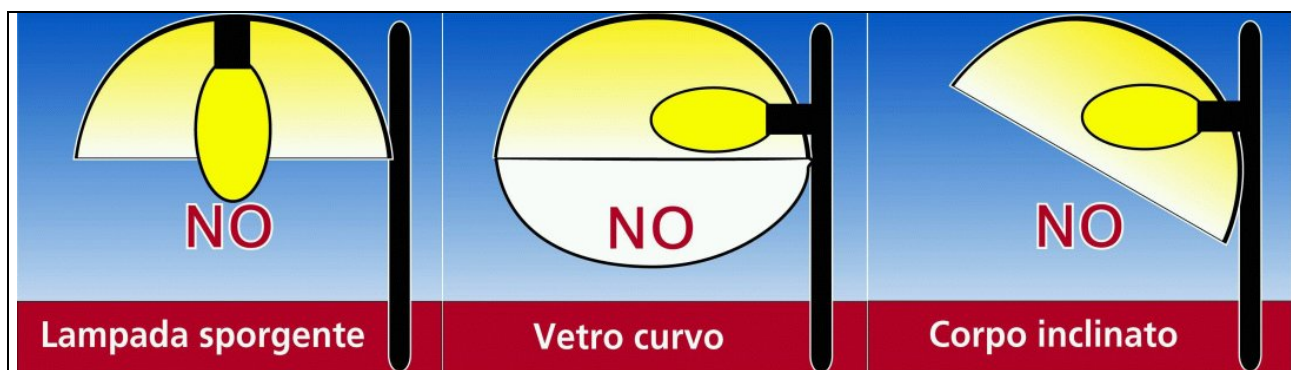
Fig.4 –Apparecchi che per configurazione non sono conformi alla L.P.16/07.
