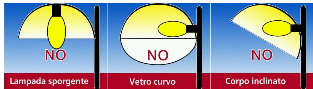
Fig.4 – Apparecchi che per configurazione non sono conformi alla D.G.R. n.48/31.
