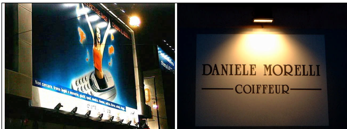
Fig.15 –Sinistra: Cartellone pubblicitario illuminato anche in modo non conforme alla D.G.R. n. 48/31 dal basso verso l'alto.
