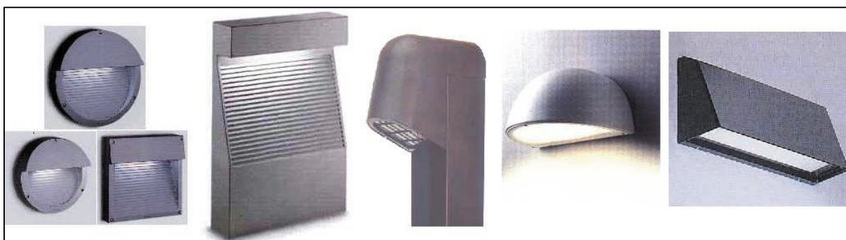
Fig. 21 – A parità di condizioni sono sempre da preferire, nonostante la deroga del 1500 lm, apparecchi con emissione inferiore a 0.49 cd/klm a 90° ed oltre come quelli in foto.
