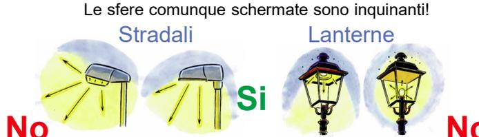
Usare solo apparecchi installati con vetro piano e orizzontale
