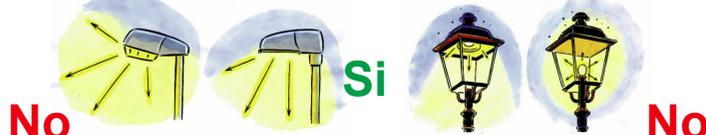
Usare solo apparecchi installati con vetro piano e orizzontale
