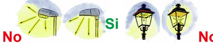
Usare solo apparecchi installati con vetro piano e orizzontale
