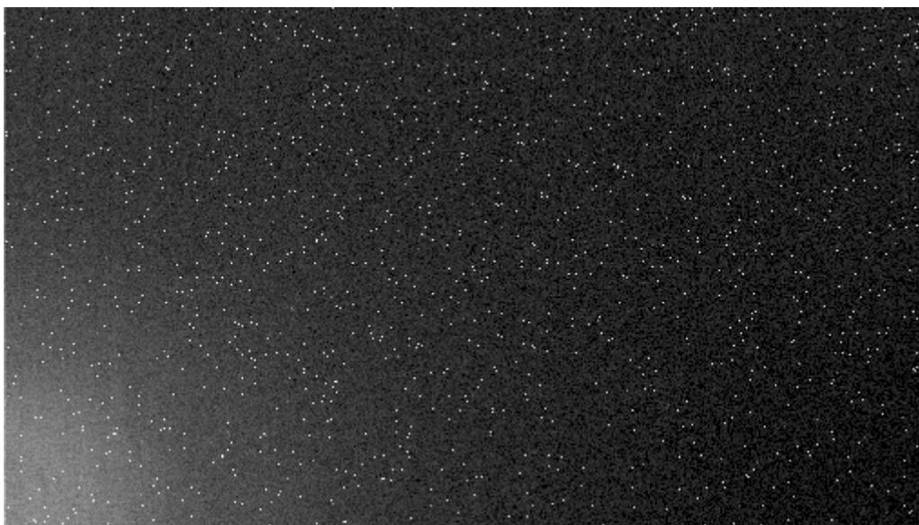
*Un dark frame (tempo di integrazione 300s): sono visibili due tipi di rumore, uno diffuso uniformemente su tutto il CCD dà origine ad alcuni pixel che appaiono bianchi, l'altro, che si presenta come un alone chiaro proveniente dall'angolo inferiore sinistro, è legato ad un difetto di raffreddamento o alla vicinanza di un componente che dissipa potenza sotto forma di calore.*
