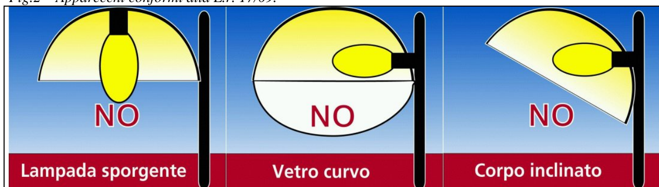
Fig. 7 –Apparecchi che per configurazione non sono conformi alla L.r. 2/10.
