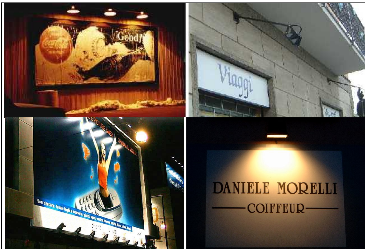
Fig. 19 – Alto-Sinistra: Insegna conforme alla L.r. 2/10 con emissione di Ocd/klm a 90° ed oltre. Alto-Destra: Proiettore inclinato solo in parte schermato dal terrazzo non conforme. Basso-Sinistra: Illuminazione dal basso di cartellone pubblicitario NON conforme alla L.r. 2/10 Basso-Destra: Insegna di modeste dimensioni e illuminata correttamente.
