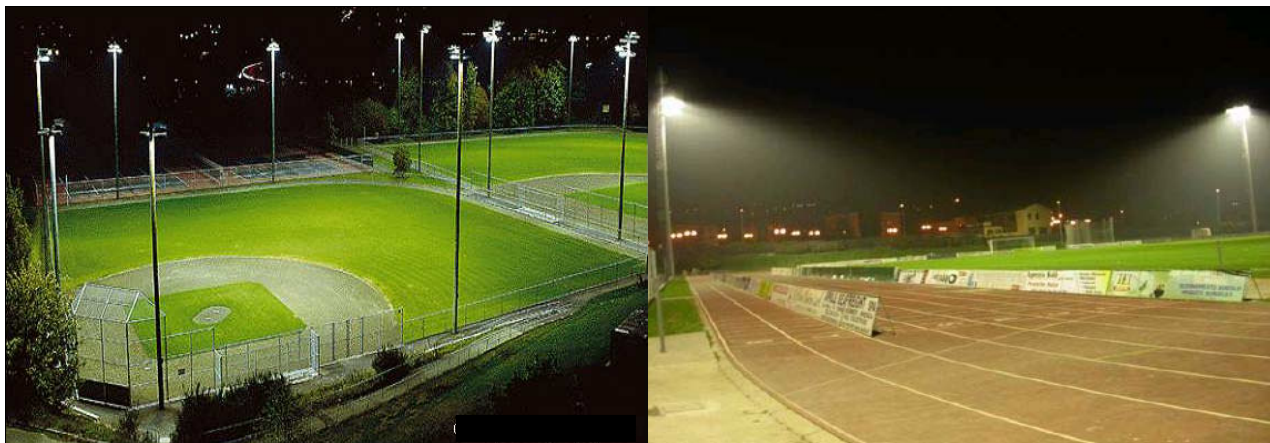
Fig. 12 – Impianti sportivi illuminati in modo conforme alla L.r. 2/10 con proiettori asimmetrici orientati orizzontalmente e che non disperdono luce verso l'alto (0.49 cd/klm a 90° ed oltre).
