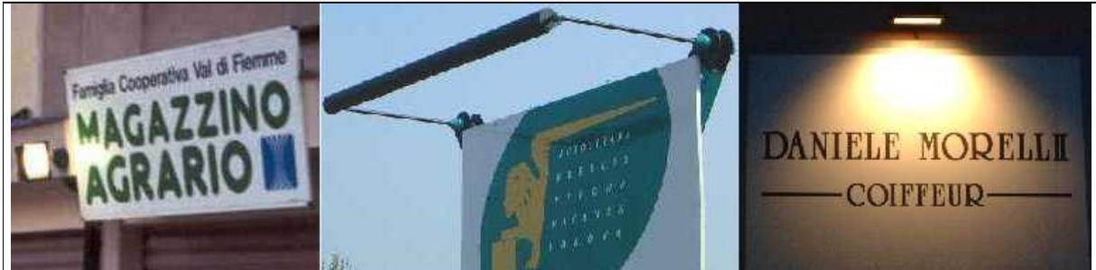
Fig.8 - Tre modi per illuminare le insegne. Nel primo (illuminazione laterale - foto a sinistra) pur evitando di illuminare dal basso ancora metà della luce viene comunque dispersa verso l'alto. Nel secondo, benché le lampade siano schermate dall'armatura (foto centrale) parte della luce esce dal bordo superiore del pannello stradale. Nel 3° impianto illuminazione dall'alto verso il basso conforme alla LR10/02.
