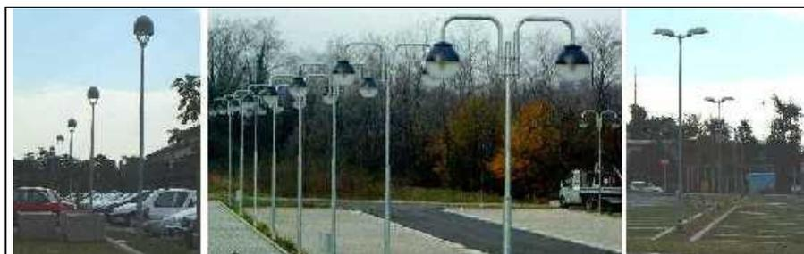
Fig.1-3 - Ai lati della foto due parcheggi conformi alla LR10/02 ed al centro uno realizzato con sfere in parte schermate comunque non conformi alla LR 10/02
