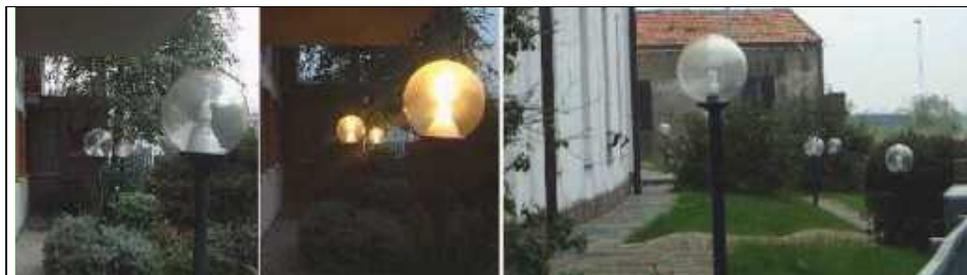
*Fig.17 – Nelle 2 foto di sinistra l'illuminazione è conforme alla deroga con 3 punti luce non schermati di max 23W a fluorescenza. Nella foto di sinistra però la deroga non è applicabile a meno che il flusso emesso verso l'alto sia inferiore a quello emesso da 3 punti luce da 23W (utilizzando ad esempio potenze inferiori o schermature).*
