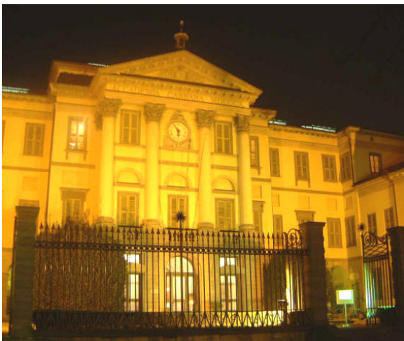
I monumenti devono essere illuminati dall'alto verso il basso. Nel caso in cui ciò non risulti possibile e per soggetti di particolare e comprovato valore architettonico, i fasci di luce devono rimanere di almeno un metro al di sotto del bordo superiore della superficie da illuminare. Nei casi riportati le condizioni non sono rispettate (D.Bonata)
