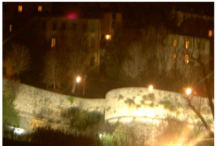
I monumenti devono essere illuminati dall'alto verso il basso. Nel caso in cui ciò non risulti possibile e per soggetti di particolare e comprovato valore architettonico, i fasci di luce devono rimanere di almeno un metro al di sotto del bordo superiore della superficie da illuminare. Nei casi riportati le condizioni non sono rispettate (D.Bonata)
