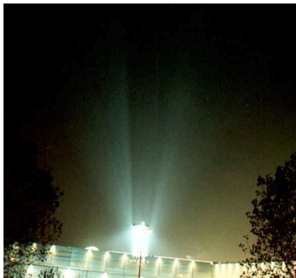
L'utilizzo della luce riflessa mediante apparecchiatura "Vela" come illuminazione urbana, residenziale, decorativa, etc.. è sempre sconsigliata in quanto tali sistemi hanno un'efficienza molto bassa ed è quasi impossibile non inviare luce verso la volta celeste! In questo caso i potenti proiettori colpiscono solo parte del corpo riflettente disperdendo il resto del flusso luminoso verso l'alto (F.Crotti)
