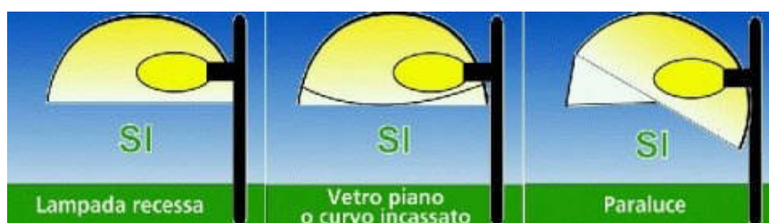
Figura 12 - Apparecchi conformi alla Legge Regionale - Fascicolo divulgativo
