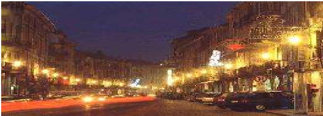
Utilizzando le lanterne tradizionali, si rischia di illuminare i piani alti dei palazzi piuttosto che la strada, l'efficienza è bassa e per ottenere un illuminamento sufficiente è necessario utilizzare un'alta densità di corpi.
