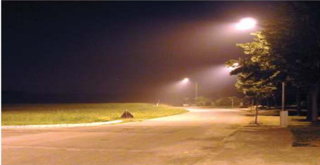
Lampioni a vetro curvo montati erroneamente su pali a sbraccio inclinato : il massimo della luminanza è visibile sul bordo opposto della strada e la luce si irradia per parecchi metri verso i campi.
