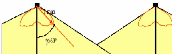
Fig. 6.17 -Osservando le curve fotometriche lungo un piano parallelo all'asse stradale si ricava l'interasse tra i pali. Per intensità massime con angoli  $\gamma$  elevati si ottengono interassi ottimali anche con apparecchi *full cut-off*.
