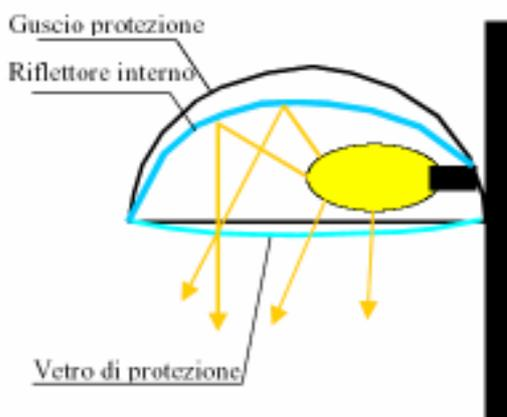
Fig. 6.7 - Un corpo illuminante è composto da un guscio di protezione, da lampada e relativo supporto, e dal sistema ottico formato da riflettore interno e vetro di protezione.
