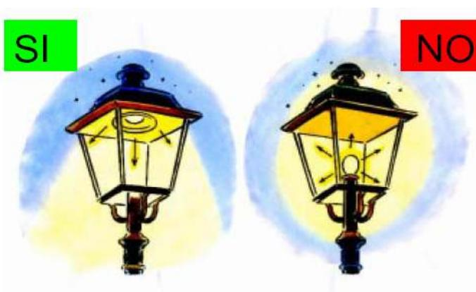
Fig. 6.22 - Lanterna schermata, a sinistra e, non schermata, a destra. La forma è identica, ma nella prima la lampada è completamente incassata all'interno dell'armatura.
