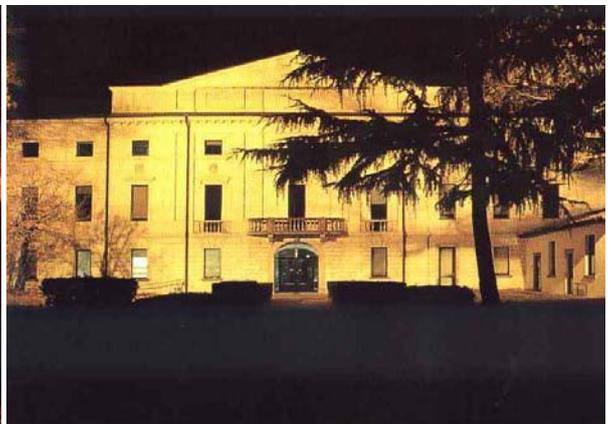
*I monumenti devono essere illuminati dall'alto verso il basso. Solo nel caso in cui ciò non risulti possibile e per soggetti di particolare e comprovato valore architettonico, i fasci di luce devono rimanere di almeno un metro al di sotto del bordo superiore della superficie da illuminare. Nel caso in questione le condizioni non sono rispettate ed inoltre il monumento di destra è sovra illuminato.*
