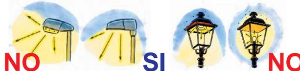
Usare lanterne con lampade recessate nel vano ottico, schermate e senza vetri di protezione (e vetro piano orizzontale)
